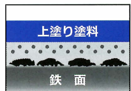
▲特殊顔料によって、水性・油性どちらの塗料でも上塗りが可能です。サビを根こそぎ封じ込めた上に、御好みの塗料で仕上げる事が可能です。
