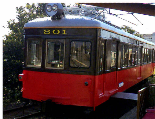
▲戦後初期に製造された歴史ある展示車両を復元しました。 (BAN-ZI AID で補修、下塗りにサビキラープロ、上塗りに当社製品サビキラーカラーを塗装)
