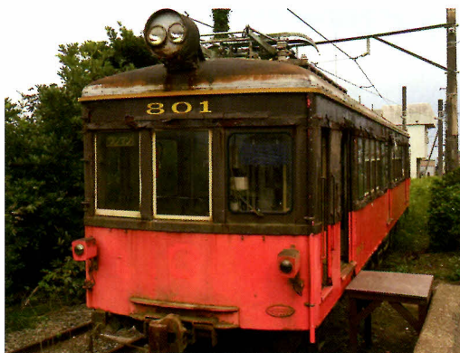
▲戦後初期に製造された歴史ある展示車両を復元しました。 (BAN-ZI AID で補修、下塗りにサビキラープロ、上塗りに当社製品サビキラーカラーを塗装)
